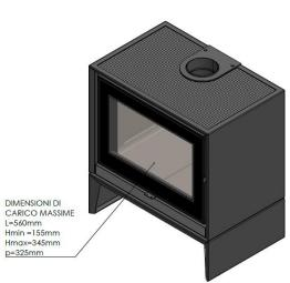
PTOT: 9,4 kW PNOM: 8,3 kW ØFUMI: 130 mm
